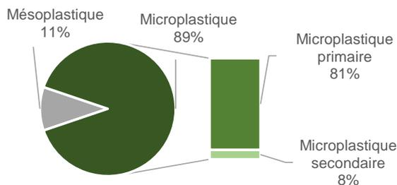
Microplastique primaire : directement produit en microparticules (ex : GPI\*) - Microplastique secondaire : issus de la fragmentation de macroplastiques
